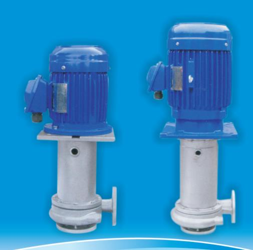
采用不锈钢304精密铸造成型,无沙孔问题,叶轮效率高 适用各种酸碱液、微酸液,循环使用,耐高温。 无轴封设计, 绝不因空运转而损坏, 设计有防止酸气进入 轴承之密封圈,及溢流导沟。 叶轮经动力平衡校正, 低噪音, 低震动
